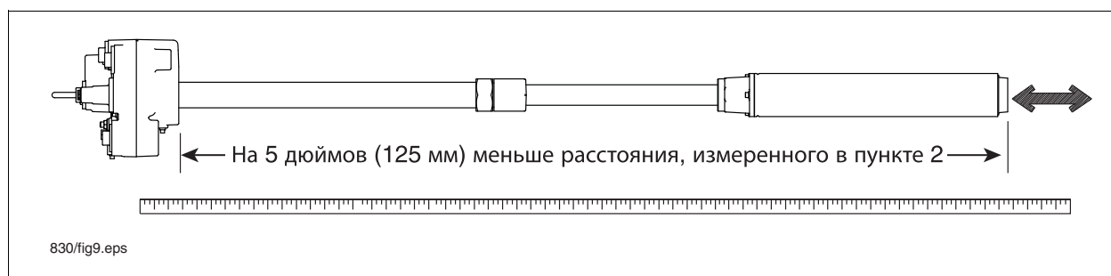
Рис. 10. Регулировка длины насоса
