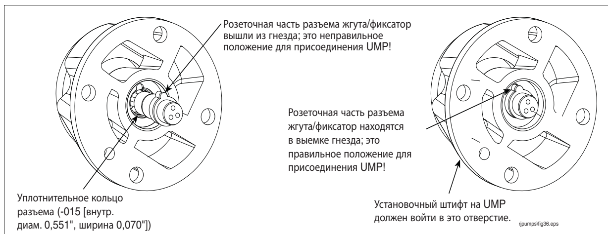
Рис. 6. Проверка правильности положения розеточной части разъема жгута
