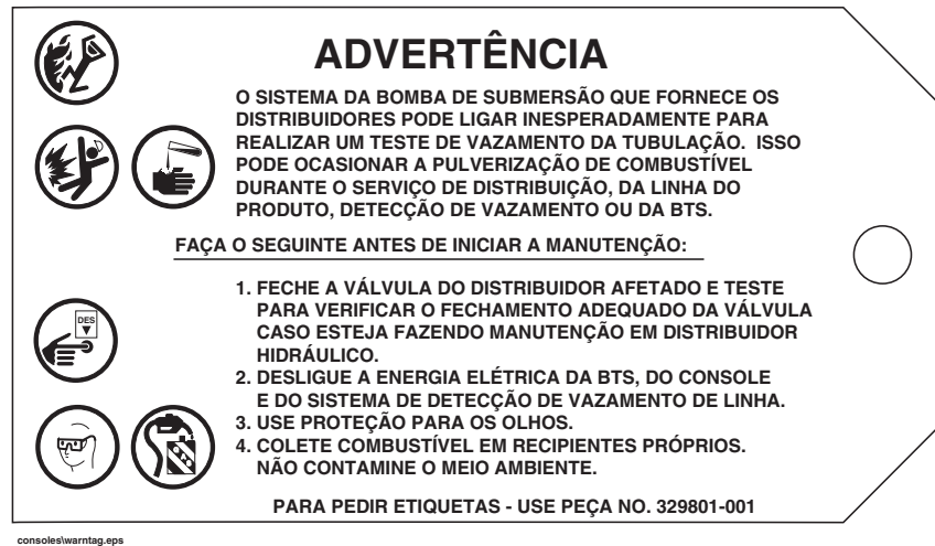
Figura 1. Etiqueta de advertência
